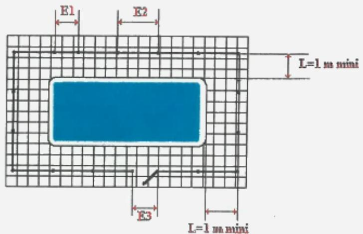
La clôture est à poser sur une chape béton ou sur plots de béton avec un dosage proche des 250kg/CPA mini. Le support doit impérativement être de niveau, plat et sain.
