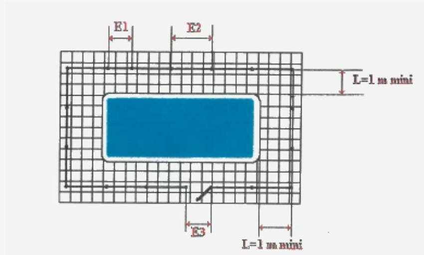
La clôture est à poser sur une chape béton ou sur plots de béton avec un dosage proche des 250kg/CPA mini. Le support doit impérativement être de niveau, plat et sain.
