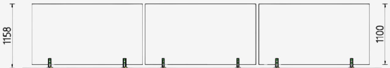
La clôture piscine AQUAZEN SP125 a une hauteur finie de 1158mm. L'espace entre le sol et le verre doit être compris entre 45 et 102mm, La clôture piscine XXXXX à un espace de 58mm.
