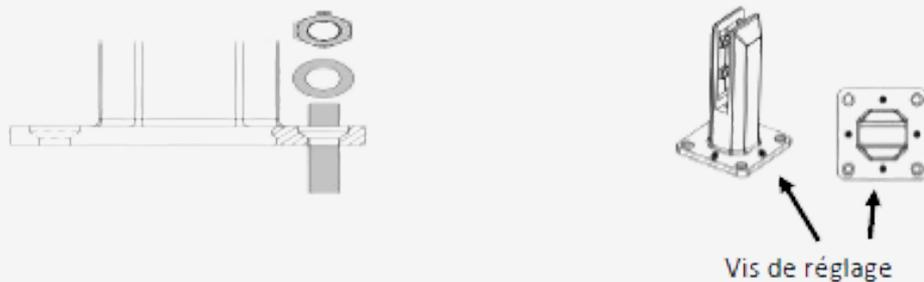
Insérez le cache platine et le joint à l'intérieur des pinces.
