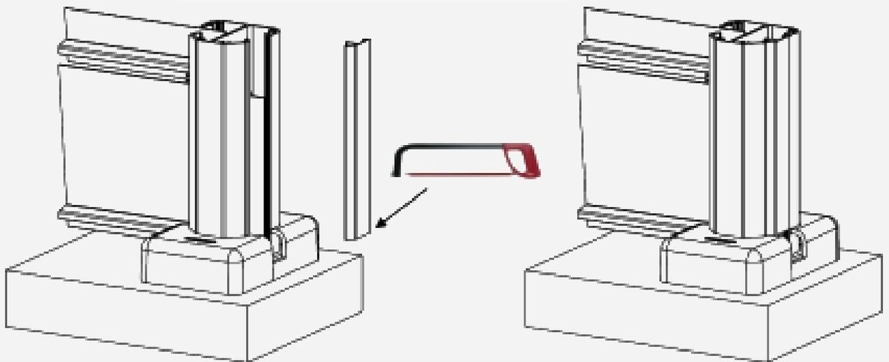
Si clôture en angle, recouper la partie du capot prévue à cet effet
