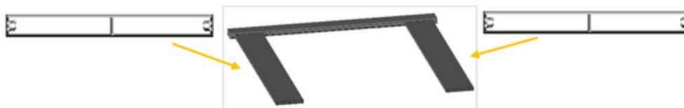
Insérer chaque traverse dans les mortaises (trous) en soulevant légèrement l'extrémité du profil pour faciliter l'opération. Assurez-vous que les traverses s'emboîtent complètement dans les montants.
