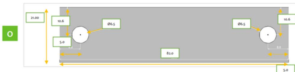
5. Vissez un capot **O** préparé à l'étape 4 à chaque extrémité du meneau **L** à l'aide des vis (6.3 x 60).
