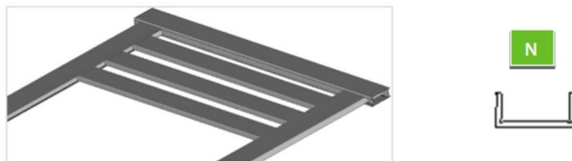
15. Clippez ensuite les capots d'extrémités **M**. Assurez-vous qu'ils ne dépassent pas de la traverse. Si tel est le cas, vérifiez que l'ensemble des capots d'extrémités, des barreaux **G** (95 x 20 mm) et des capots d'entretoises **N** (21 x 9 mm) soient en butée sur toute la longueur de la traverse.
