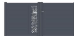
4. Préparation du meneau **L** : Percez les deux capots (21 x 9 mm) suivant le plan à l'aide d'un foret de 6.5 mm.
