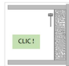
Emboîtez la tôle **N** à l'aide du maillet : le capot de tôle **M** doit se clipper sur le montant.
