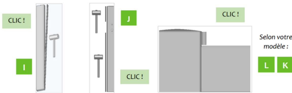
2. Insérez la serrure dans le montant et vissez le barillet. Pré-percez à l'aide d'un foret de diamètre 4 mm, puis fixez-le à l'aide des vis 4,8 x 25 TF fournies. Ensuite, installez la poignée.
