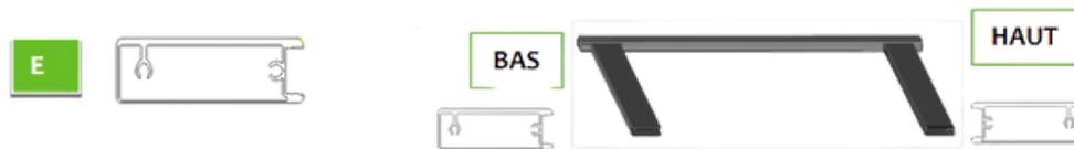
Emboîtez chaque traverse dans les mortaises (trous) en soulevant légèrement l'extrémité du profil pour faciliter l'opération.
