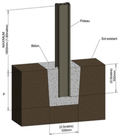
2. Assembler les poteaux et scellez-les à l'aide du mélange à béton
