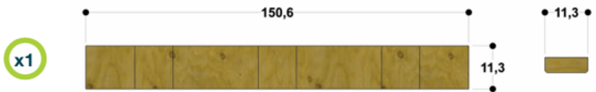
Lames de bois intérieures
