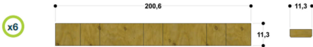
Lames de bois intérieures
